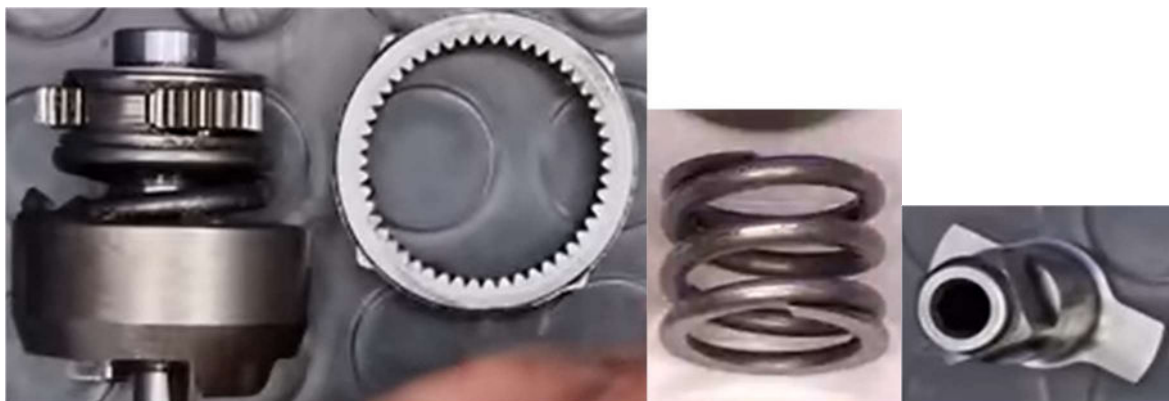
Figure 2 : Vue des pièces constitutives de l'ensemble mécanique (Marteau et réducteur, ressort, arbre de sortie).
