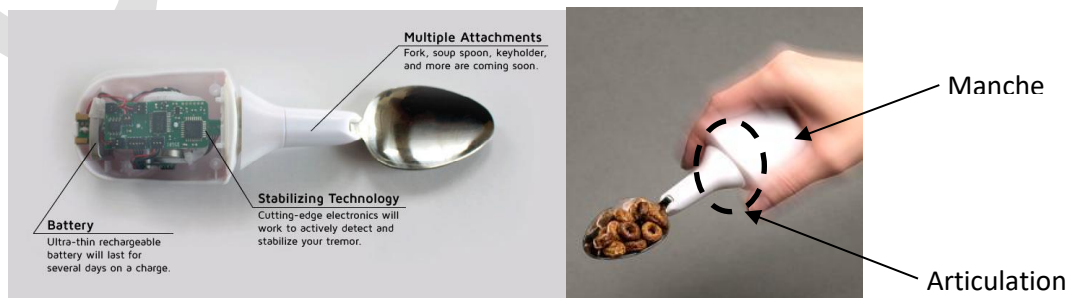
Figure 2 : Descriptif de la cuillère stabilisatrice
