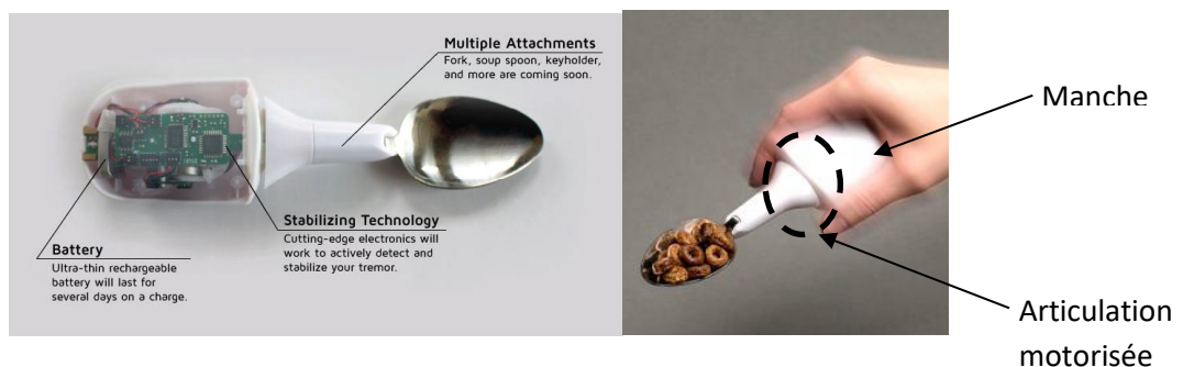
Figure 2 : Descriptif de la cuillère stabilisatrice
